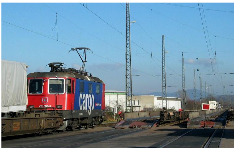
Abbildung 26: RoLa-Verladeanlage in Freiburg i Br mit mobilen Verladerampen Foto: Reinhard Reiss, Quelle: EBP
