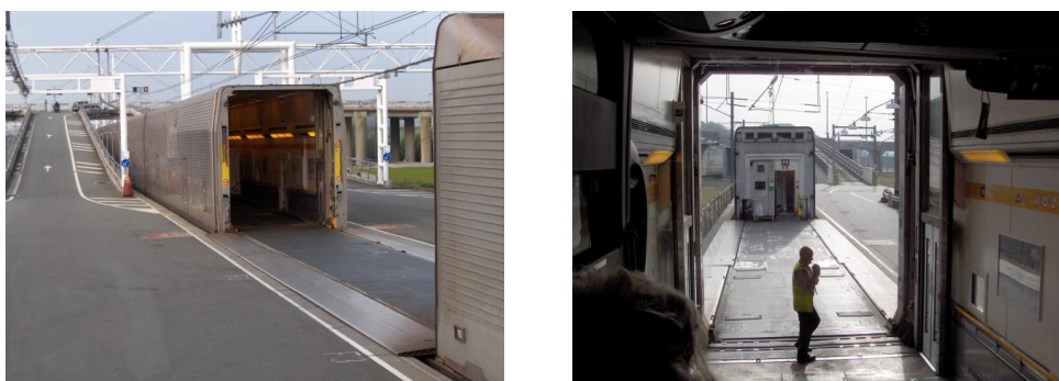
Abbildung 27: Verladeanlage für den Eurotunnel mit einem Auffahrwagen für seitliches Auffahren, Quelle: EBP
